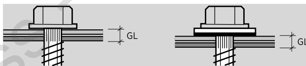
FIGUR RA ZSE.2/2. PRINCIP FÖR FRISLÄPPETS GREPLÄNGD.
